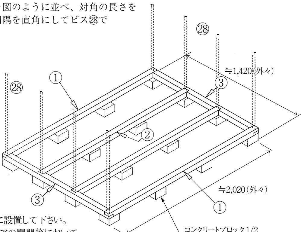
注:ブロックは必ず水平に設置して下さい。
