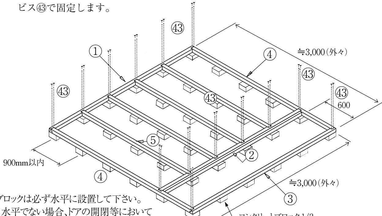
注: ブロックは必ず水平に設置して下さい。
