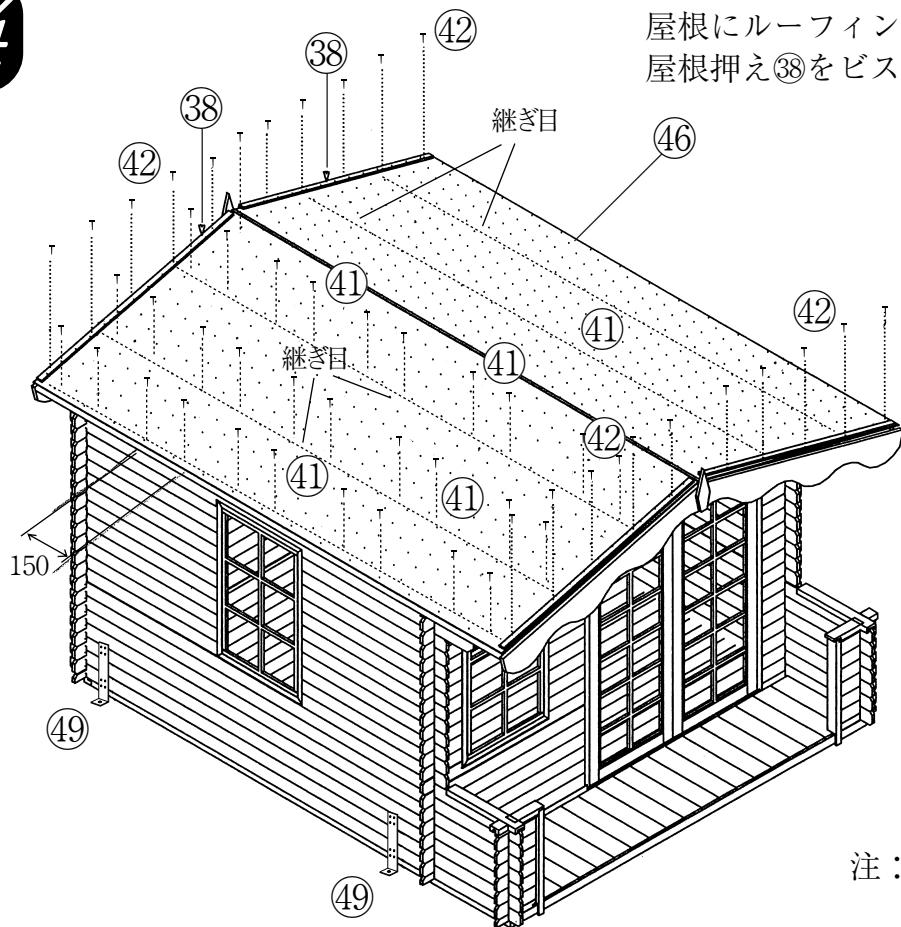
屋根にルーフィングフェルト④〇を敷き、屋根押え③〇をビス④〇で打ち付けます。
