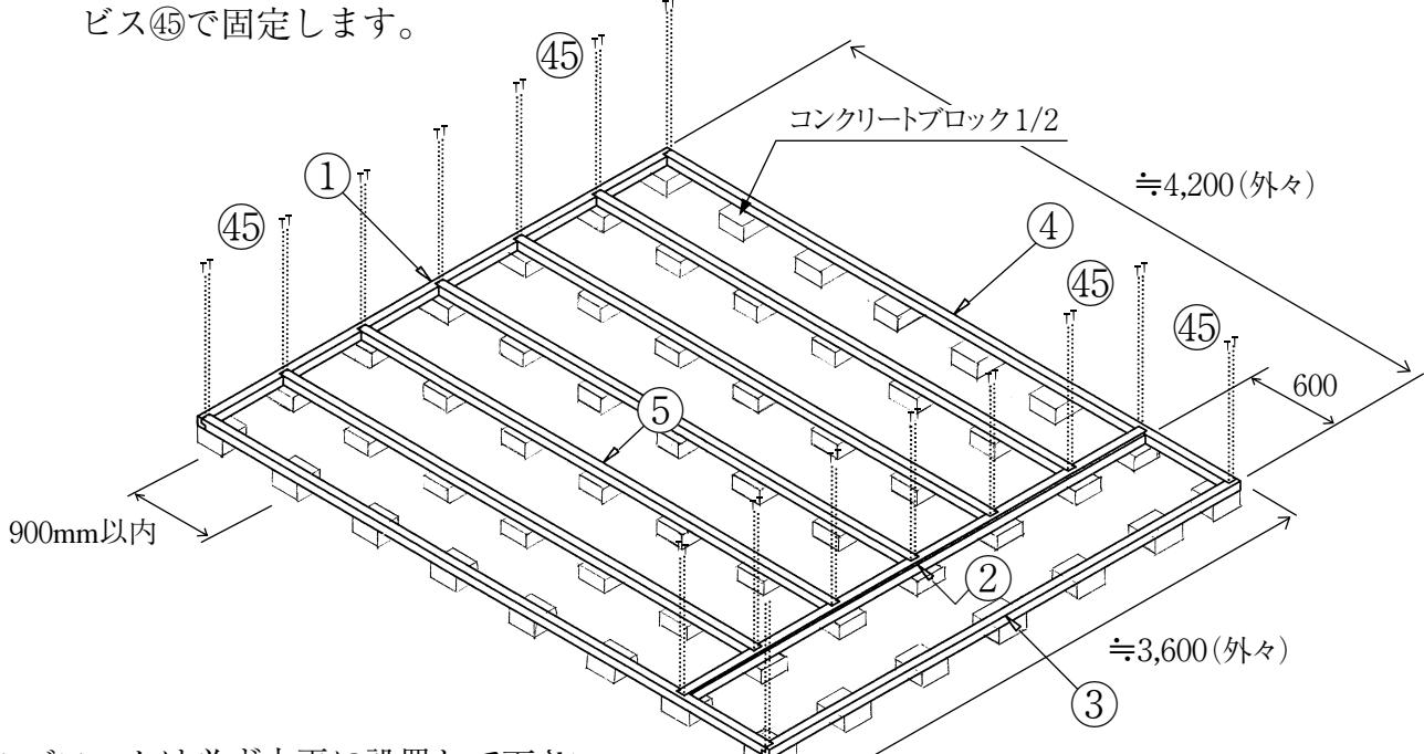
注：ブロックは必ず水平に設置して下さい。
